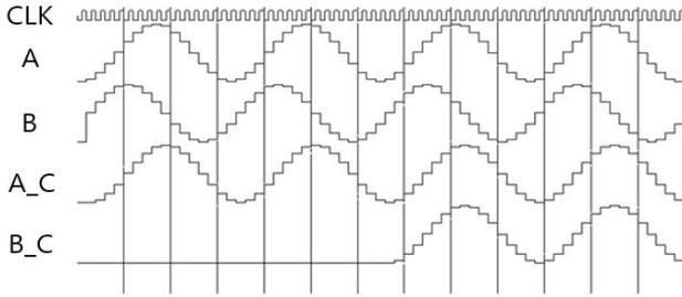
Fig. 5 Wave of Phase shift
